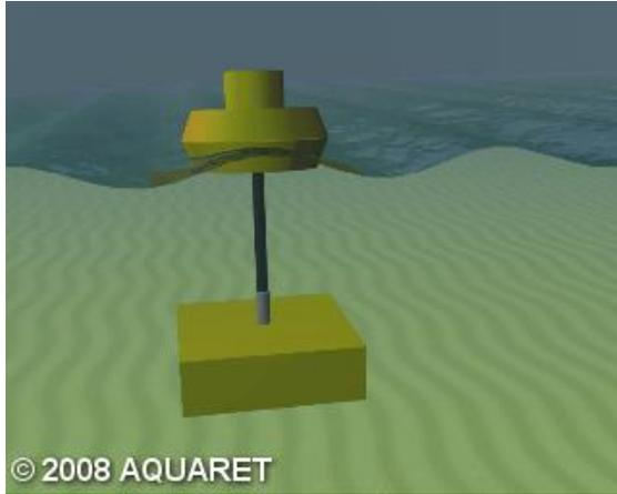
شکل ۳- نمایی از یک جذب کننده‌ی نقطه‌ای [4]
