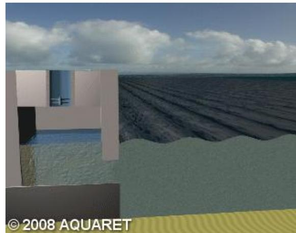
شکل ۵- نمایی از یک مبدل نوسانی ستون آب [4]
